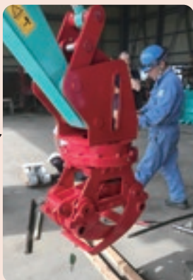
開発したグラップル制動装置「グリッパー®」の一例
